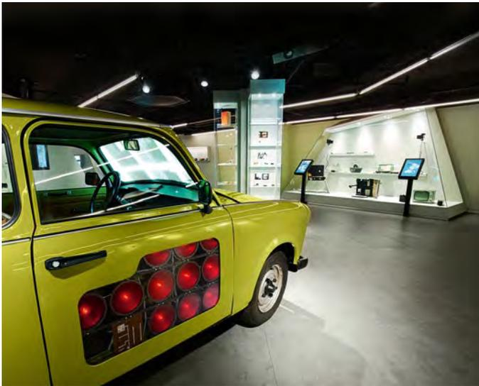
Spionage-Trabant mit Infrarot-Blitzlicht
